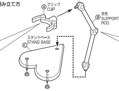
\*キャップを外して支柱を取り付けることができます。
